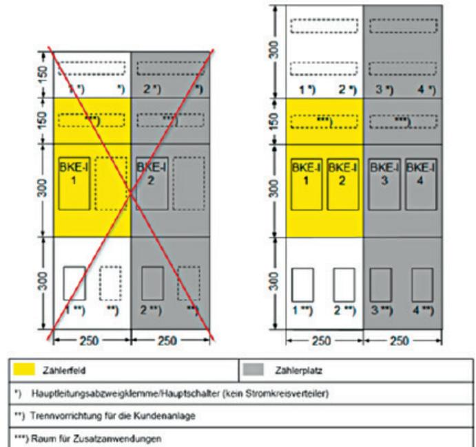
Abbildung 2: Zählerplätze mit BKE-I Befestigung
