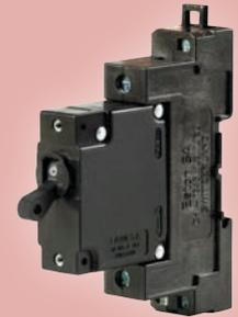
Interruttore magneto-idraulico per applicazioni AC e DC. Da utilizzare unitamente ad un organo protettore del circuito di derivazione (se è necessaria una protezione del circuito di derivazione). L'unità è montata su guida DIN e può avere contatti ausiliari (NC o NA) sullo stesso polo.
