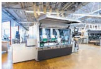
La profilatrice quadrilaterale per la lavorazione delle travi è in grado di trasformare fino a 600 m di legno in un minuto.
