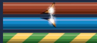
**Défaut d'arc parallèle** – provient d'un défaut entre la phase et le neutre. Le courant total dans le circuit augmente selon l'impédance de charge et l'impédance de défaut.
