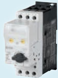
Der PKE ist ein Motor- und Anlagenschutzschalter mit modularen Auslöseblöcken, dessen Überlastschutz elektronisch realisiert wird. In Kombination mit SmartWire-DT liefert er Daten wie Echtzeitanzeige der Lastströme, erweiterte Warnungen für kritische Zustände sowie umfassende Diagnosedaten.
