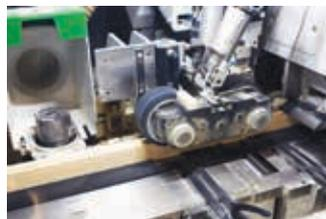
Les rouleaux d'alimentation assurent le transport du bois à travers la machine où il est usiné avec des outils spéciaux, tel que le rabot, pour atteindre la forme requise.
