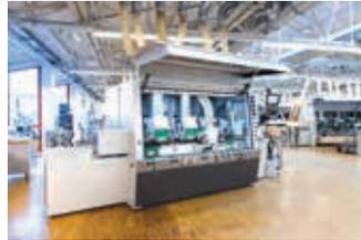
La raboteuse-moulinière à quatre faces pour un travail latéral sur les poutres de bois et le profilage des moulures est en mesure de traiter jusqu'à 600 m de bois par minute.
