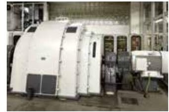
Der Stoßgenerator im Prüflabor von I<sup>2</sup>PS, rechts der neue Asynchronmotor, links hinten der offene Schaltschrank mit der Eaton-Antriebslösung
