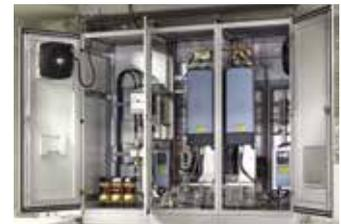
Der luftgekühlte Frequenzumrichter SPI mit Rückspeiseeinheit SPA von Eaton speist die Bremsenergie des Motors zurück ins Netz
