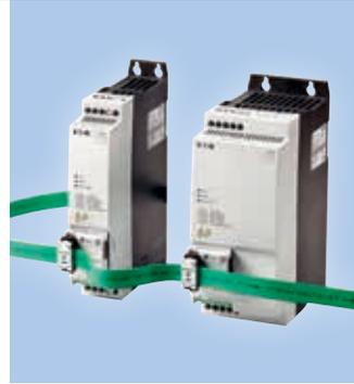
Der neue PowerXL™ DE1 Drehzahlstarter schließt die Lücke zwischen konventionellem Motorstarter und dem Frequenzumrichter unter Ausnutzung der Vorteile beider Gerätearten – die einfache Handhabung des Motorstarters und die variable Motordrehzahl des Frequenzumrichters in einem Gerät.
