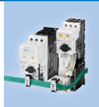
Der PKE ist ein Motor- und Anlagenschutzschalter mit modularen Auslöseblöcken, dessen Überlastschutz elektronisch realisiert wird. Der Zwei-Komponenten-Motorstarter, bestehend aus Leistungsschutzschütz DILM und Motorschutzschalter PKE, eignet sich für den einfachen Komponentenaustausch durch steckbare Verbindungstechnik bis 15 A Nennstrom.
