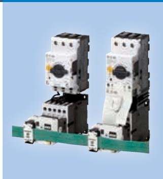
Der Zwei-Komponenten-Motorstarter, bestehend aus Leistungsschutzschütz DILM und Motorschutzschalter PKZ, eignet sich für den einfachen Komponentenaustausch durch steckbare Verbindungstechnik bis 15 A Nennstrom. Zusätzlich lassen sich die Motorstarter bis 32 A mit Montageverbinder schnell und fehlerfrei aufbauen.
