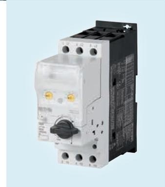
Der PKE ist ein Motor- und Anlagenschutzschalter mit modularen Auslöseblöcken, dessen Überlastschutz elektronisch realisiert wird. In Kombination mit SmartWire-DT liefert er Daten wie Echtzeitanzeige der Lastströme, erweiterte Warnungen für kritische Zustände sowie umfassende Diagnosedaten.
