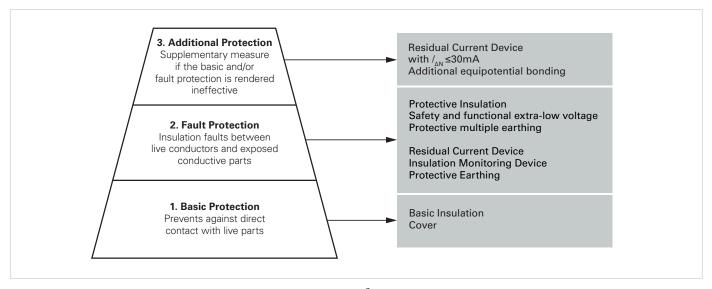
Fig. 4: Three-stage protection strategy (Source: Elektroschutzkonzept der ÖVE)
