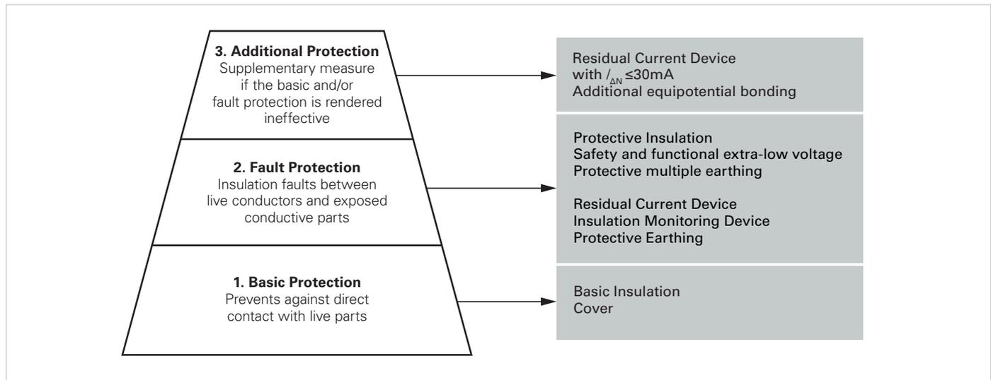
Fig. 4: Three-stage protection strategy (Source: Elektroschutzkonzept der ÖVE)
