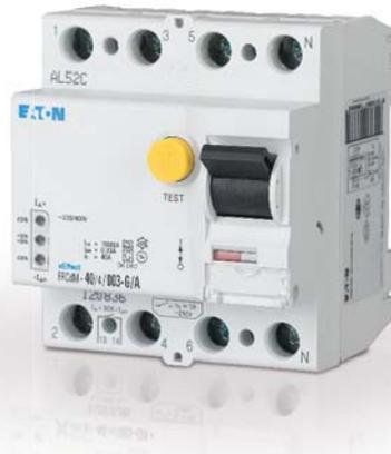
L'affichage électronique permet un diagnostic en temps réel directement sur l'interrupteur différentiel. Grâce aux LED, le statut de l'installation est visible à tout moment en un coup d'œil. Un contact sans potentiel permet le raccordement à un système de surveillance.
