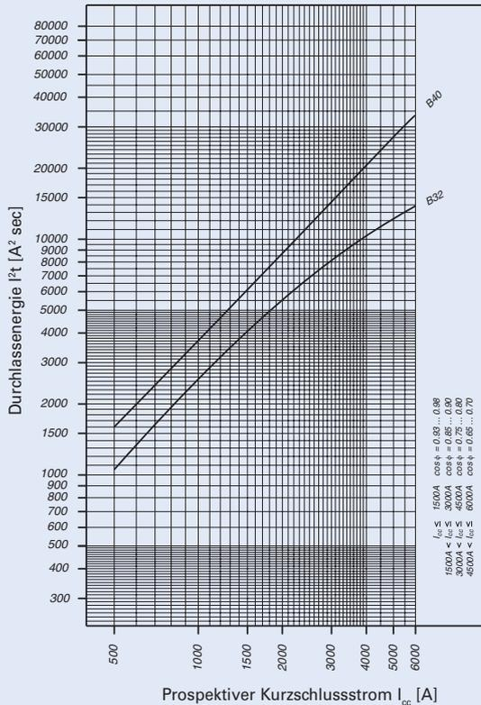
Durchlassenergie AFDD+, Kennlinie C, 2-polig, 32-40 A
