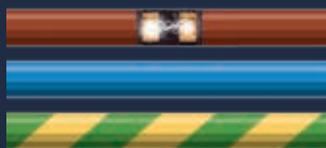
**Serielle Fehlerlichtbögen** – treten am häufigsten auf. Sie entstehen aus Fehlerströmen an Phase oder Neutraleiter. Sie lassen sich nur mit einem AFDD+ erkennen.
