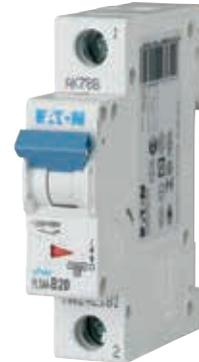
Überlaststrom kann gefährliche Verlustleistung am Kabel verursachen, die eine Überhitzung und Beschädigung des Kabels nach sich zieht. Leitungsschutzschalter vereinen einen vergleichsweise langsamen, stromabhängigen Schutz vor Überstrom mit extrem schnellem Schutz vor stromunabhängigen Kurzschlüssen.
