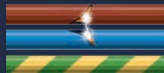
**Parallele Fehlerlichtbögen** – resultieren aus einem Fehler zwischen Phase und Neutraleiter. Die Gesamtstromstärke im Stromkreis steigt abhängig von Ladungswiderstand und dem Fehlerwiderstand an.
