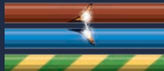
**Archi in Parallelo** - si generano fra fase e neutro o fase e terra. Ad elevata impedenza per cui generano una corrente in genere bassa. Rilevabili solo da AFDD o, nel migliore dei casi, da Differenziale in caso di arco verso terra.
