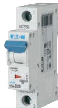
Una corrente superiore alla nominale del circuito, porta ad un'innalzamento delle temperature e quindi all'invecchiamento precoce dell'isolante. Gli MCB combinano una protezione a tempo lungo (Termica) contro i sovraccarichi ad una ad intervento istantaneo (Magnetica) contro i cortocircuiti
