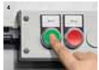
4 Einschalten. Der Motor läuft drehzahl geregelt.
