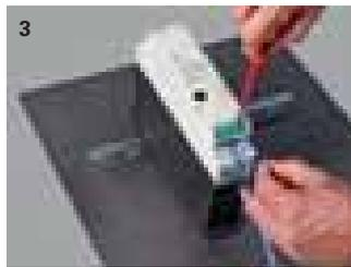
3 Steuerstrom verdrahten.
