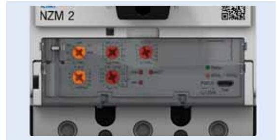
**Als Einspeiseschalter übernimmt der NZM natürlich auch den sekundärseitigen Überlastschutz des Transformators. Eine Variante mit zeitverzögerten Kurzschlussauslösern erlaubt zeitselektiven Netzaufbau. Diese Lösung eignet sich insbesondere bei Transformator- oder Generatoreinspeisung sowie bei langen Leitungen in IT- und TN-Netzen.**
