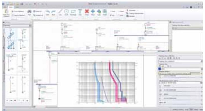
Auslösekennlinie des NZM4 mit aktiviertem Arc Reduction Maintenance System – Instandhaltungssystem zur Lichtbogenreduzierung (ARMS)
