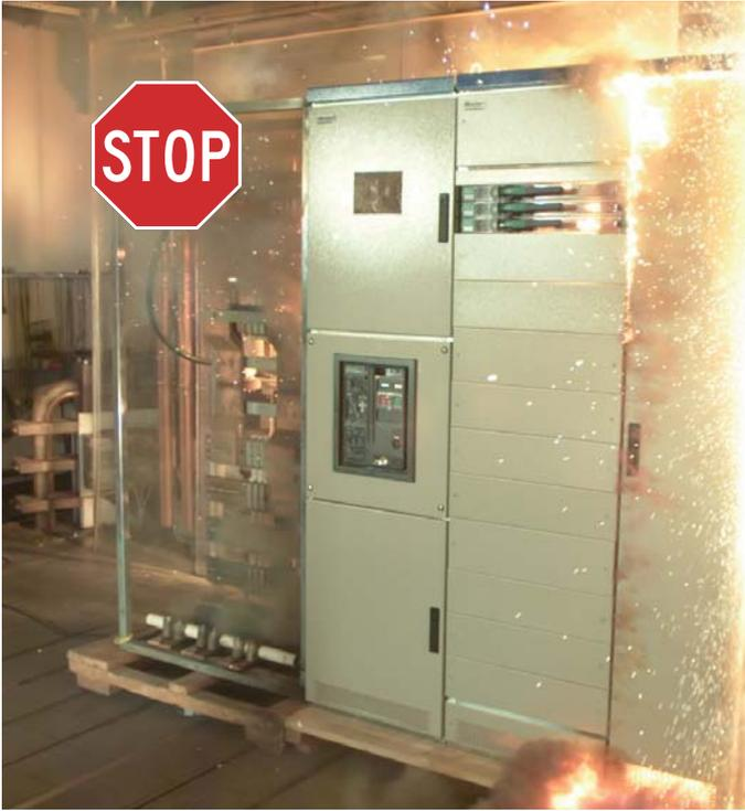
Kurzschlüsse in elektrischen Anlagen können eine enorm zerstörerische Wirkung entfalten und Menschenleben gefährden. Das trifft insbesondere auf Kurzschlüsse zu, die einen Lichtbogen auslösen. Elektrische Störlichtbögen stellen eine fehlerhafte Verbindung zwischen Anlagenteilen unterschiedlichen Potentials her. Dabei werden enorme Mengen an Energie freigesetzt, die in erster Linie als Wärme- und Druckenergie sehr hoher Intensität an die Umgebung abgegeben werden.
