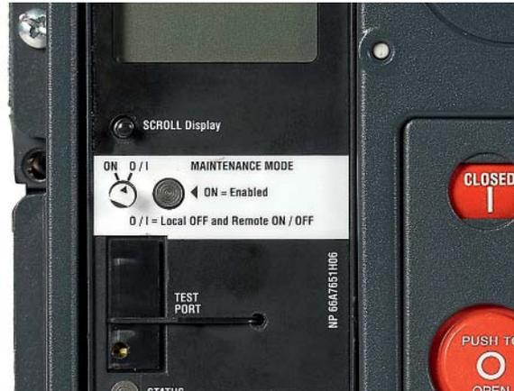
Durch die Erweiterung des Eaton IZMX Leistungsschalters mit individuellen Lösungen wird die Sicherheit der Anlage zusätzlich erhöht und im Fehlerfall Personal besser geschützt. Dieses System garantiert noch mehr Sicherheit für das Wartungspersonal. Durch die Aktivierung dieser Funktion im Wartungsmodus wird die Einstellung für sofortiges Auslösen des IZM Leistungsschalters so weit reduziert, dass die frei werdende Energie (Strahlung, Druck, Temperatur) im Falle eines
