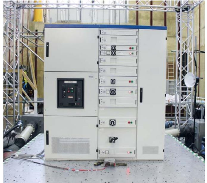
Das Thema Erdbebensicherheit hat bei Eaton höchste Priorität. Das xEnergy System ist eine robuste Konstruktion, die Erdbeben tests den strengsten Normen entsprechend unterzogen wurde. xEnergy Schaltanlagen-systeme wurden so konzipiert, dass sie für den Einsatz in gefährdeten Gebieten bes-
